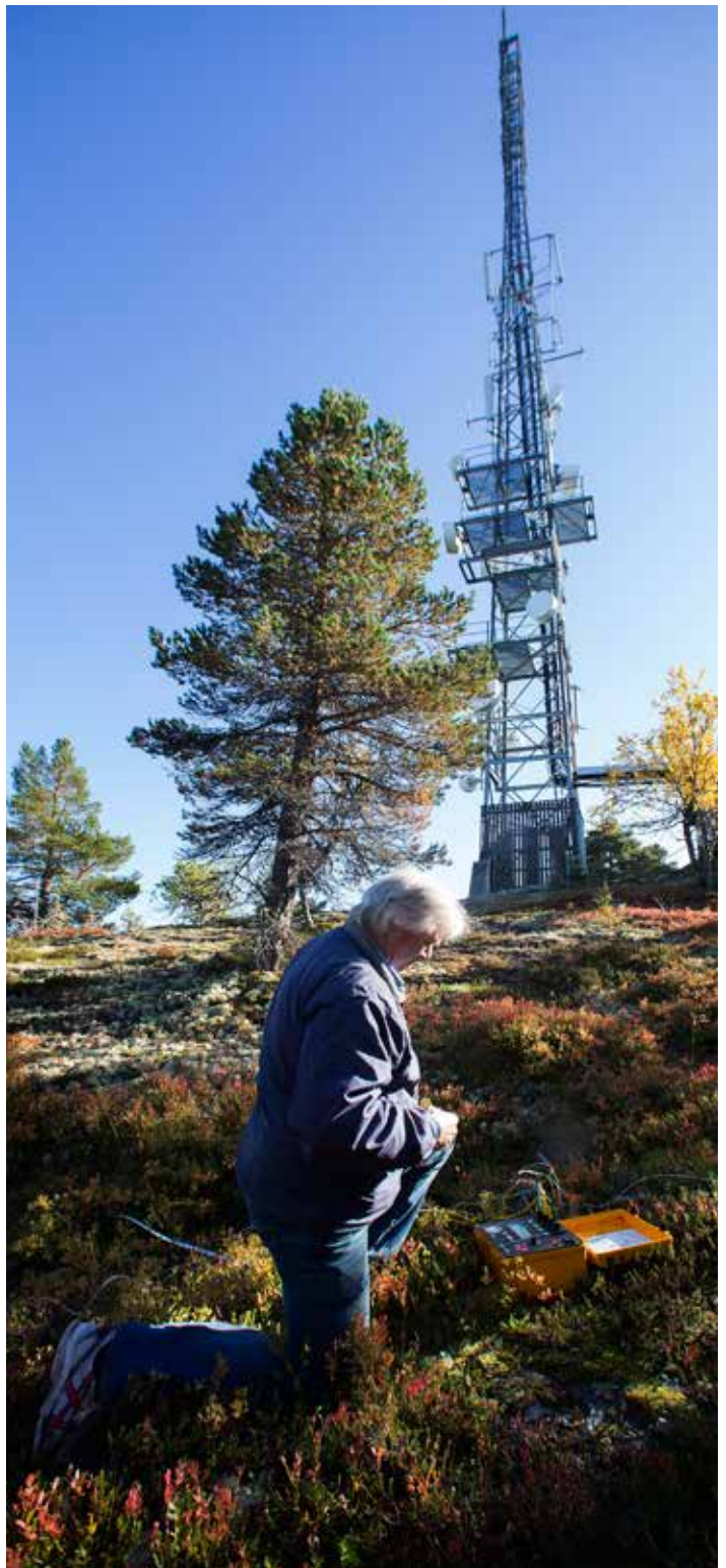
Sjekker fjellet: Høstfet utfører en jordresistivitetsmåling for å kunne beregne berggrunnens elektriske ledningsevne.
