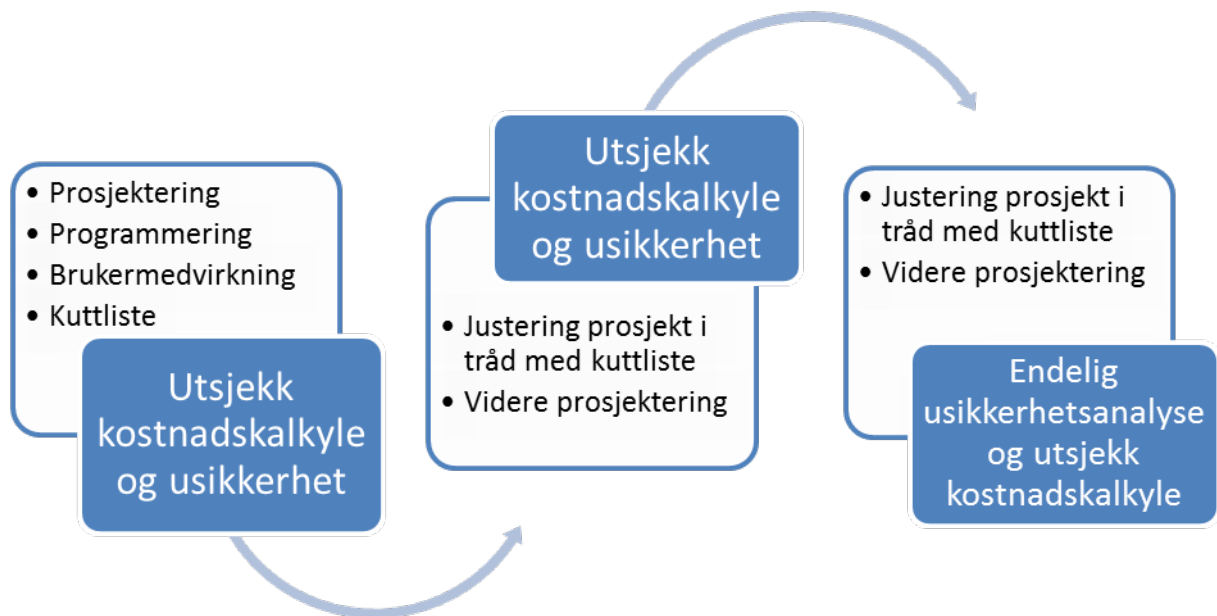
Figur 3. Modell for kostnadsstyrt prosjektering i forprosjektet
