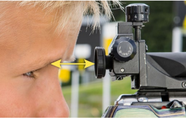
Anbefalt avstand mellom øye og diopter er 2-4 cm.
